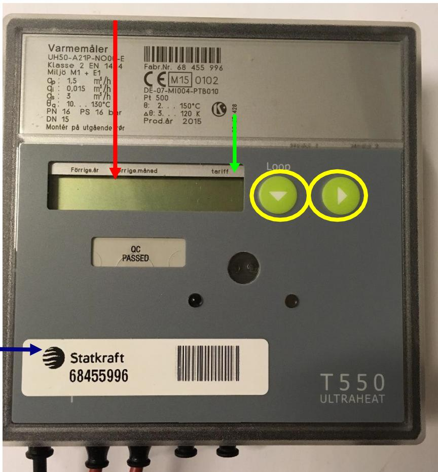
Energimåleren måler varmeenergi i kWh.
