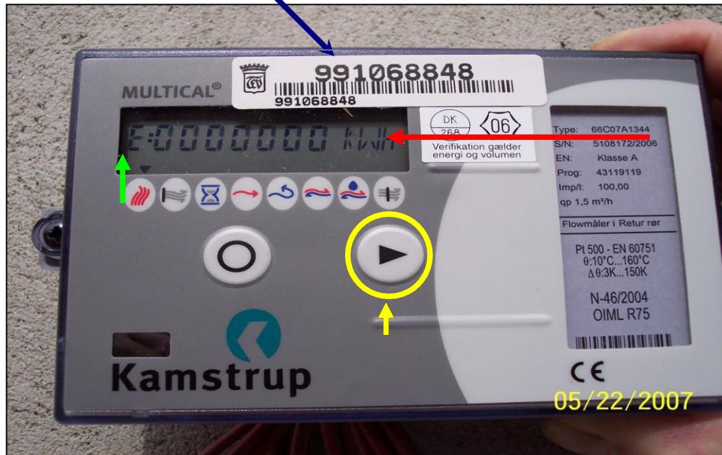
Energimåleren måler varmeenergi i kWh.
